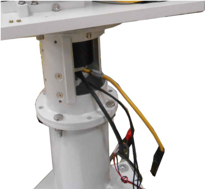
Рисунок 22 – Демонтаж переходной панели ОПУ вместе с кожухом
